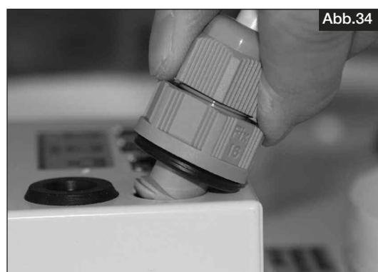
5. Zweiteilige Kabelverschraubung gegenkontern und festschrauben (Abb.35).
