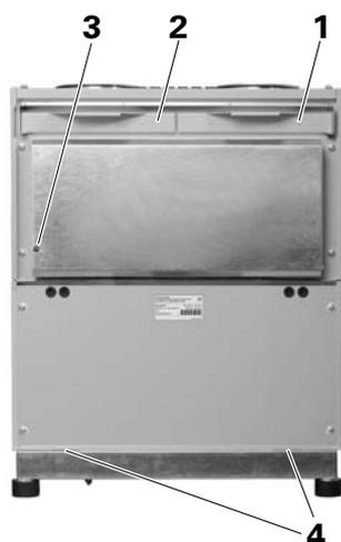
Schnappverschlüsse verriegeln. Der Kontaktschalter (3) wird geschaltet und das Gerät läuft automatisch an.
