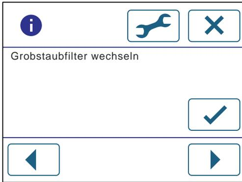
Wechseln Sie die Grobstaubfilter im Gerät (siehe Kapitel Filter / Filter wechseln).
