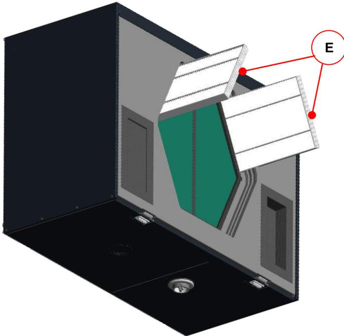
Abb. 41: Herausziehen der Filter
