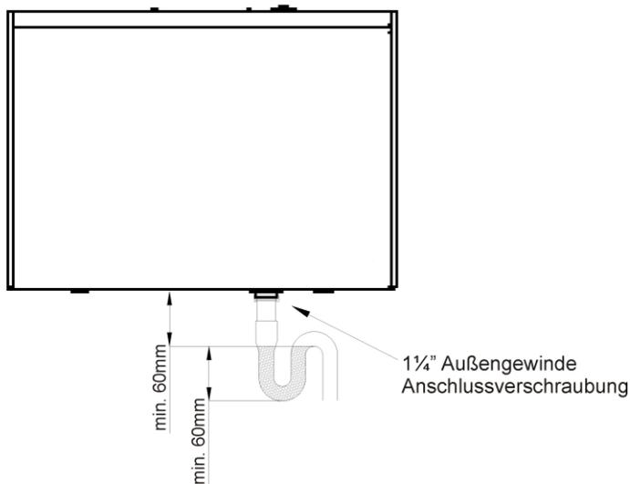
Abb. 30: Kondensatanschluss (Version LINKS)
