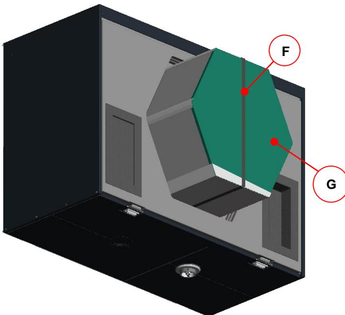
Abb. 42: Entnehmen des Wärmetauschers
