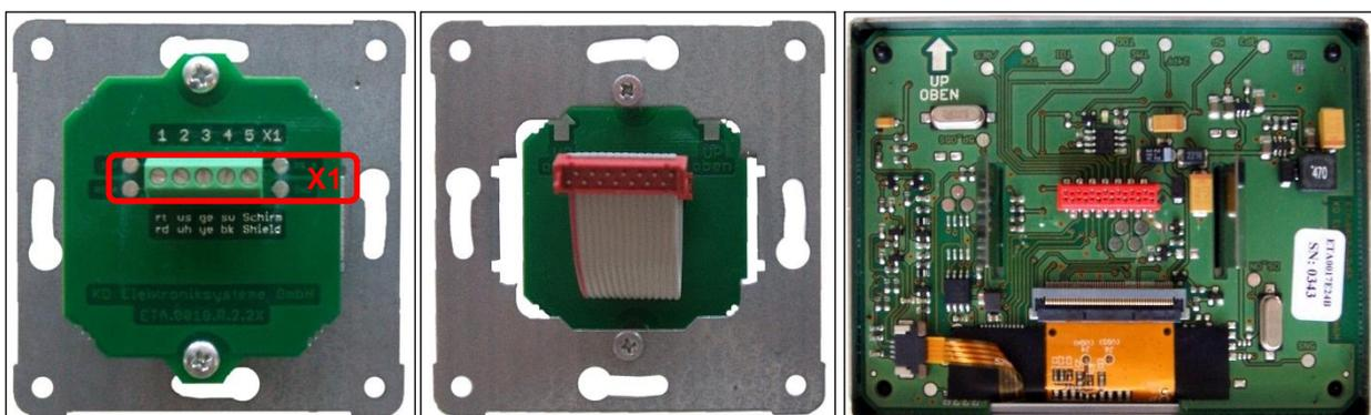
Abb. 34: Anschlussplatine mit Klemme X1 auf UP-Tragplatte; Bandkabel der Anschlussplatine; Platine TFT-Touchpanel (von links nach rechts)
