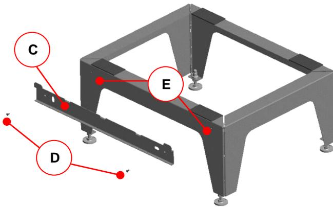
Abb. 25: Montage des Befestigungsbleches an das Fußteil
