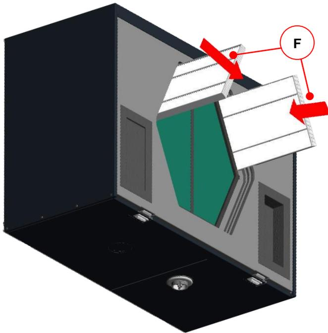
Abb. 15: Einsetzen der neuen Filter entsprechend der Durchströmungsrichtung
