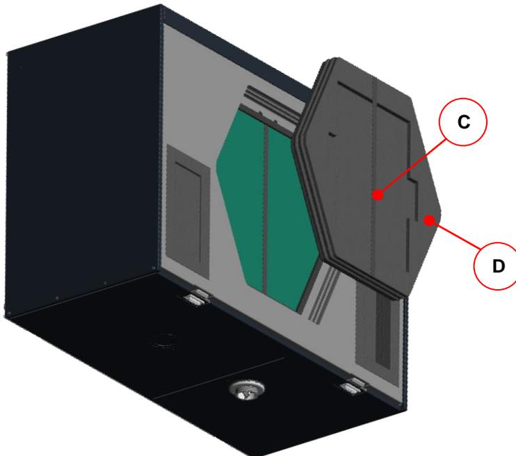
Abb. 40: Herausziehen der EPP-Schaumstoffabdeckung
