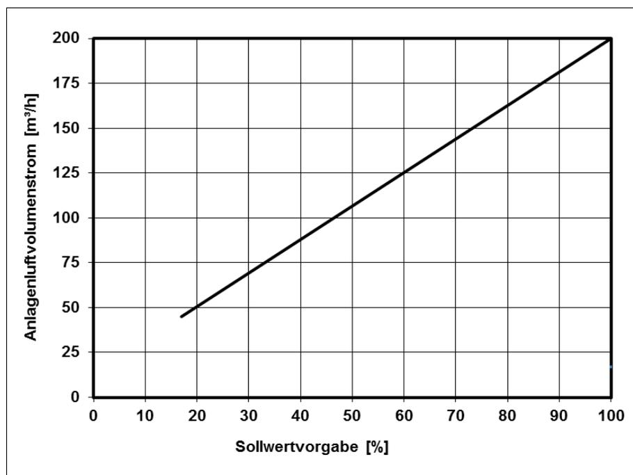
Abb. 37: Diagramm 1, Einstellwerte Nennluftvolumenstrom FOCUS mit Lüfterstufe 2 (LS2)
