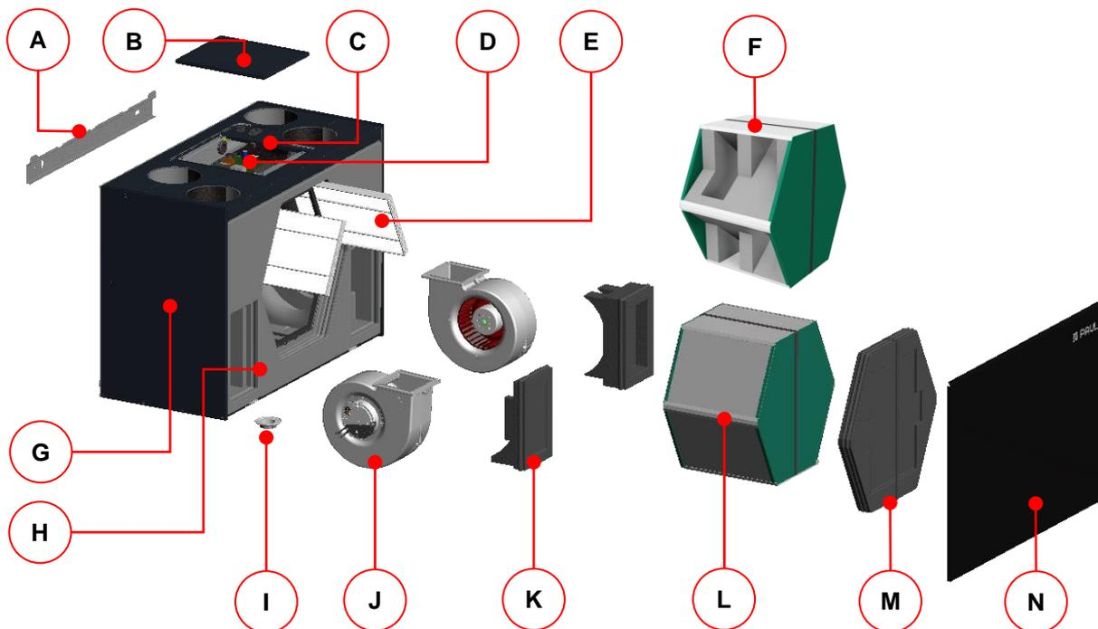
Abb. 1: Hauptkomponenten des Wärmerückgewinnungsgerätes FOCUS
