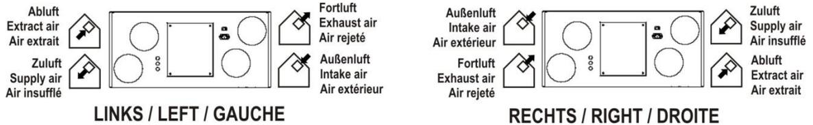
Abb. 27: Anordnung Luftanschlüsse Geräteversion LINKS und Geräteversion RECHTS
