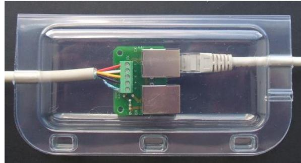
Abb. 33: Gehäuse für Adapterplatine
