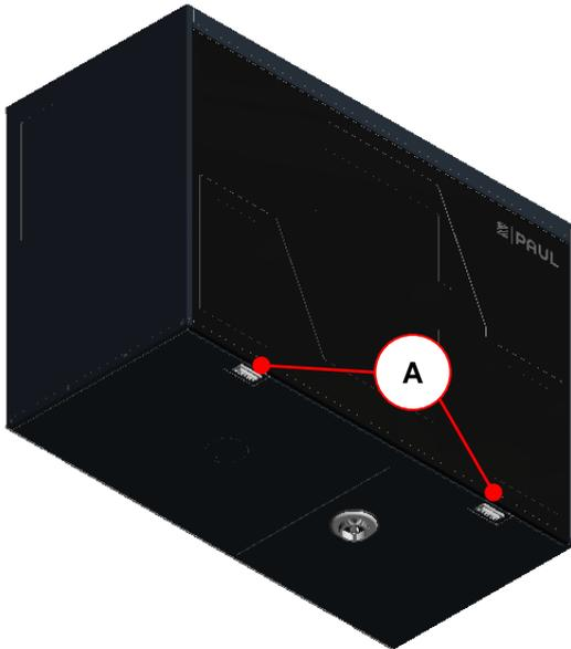
Abb. 11: Drücken der Schnappverschlüsse
