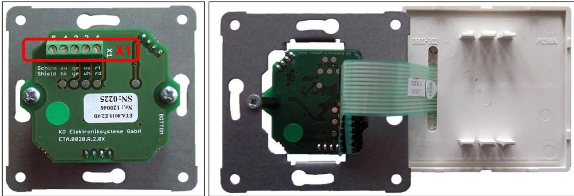
Abb. 36: Anschlussplatine mit Klemme X1 auf UP-Tragplatte; Bandkabel der Anschlussplatine; Rückseite LED-Bedienfolie (von links nach rechts)
