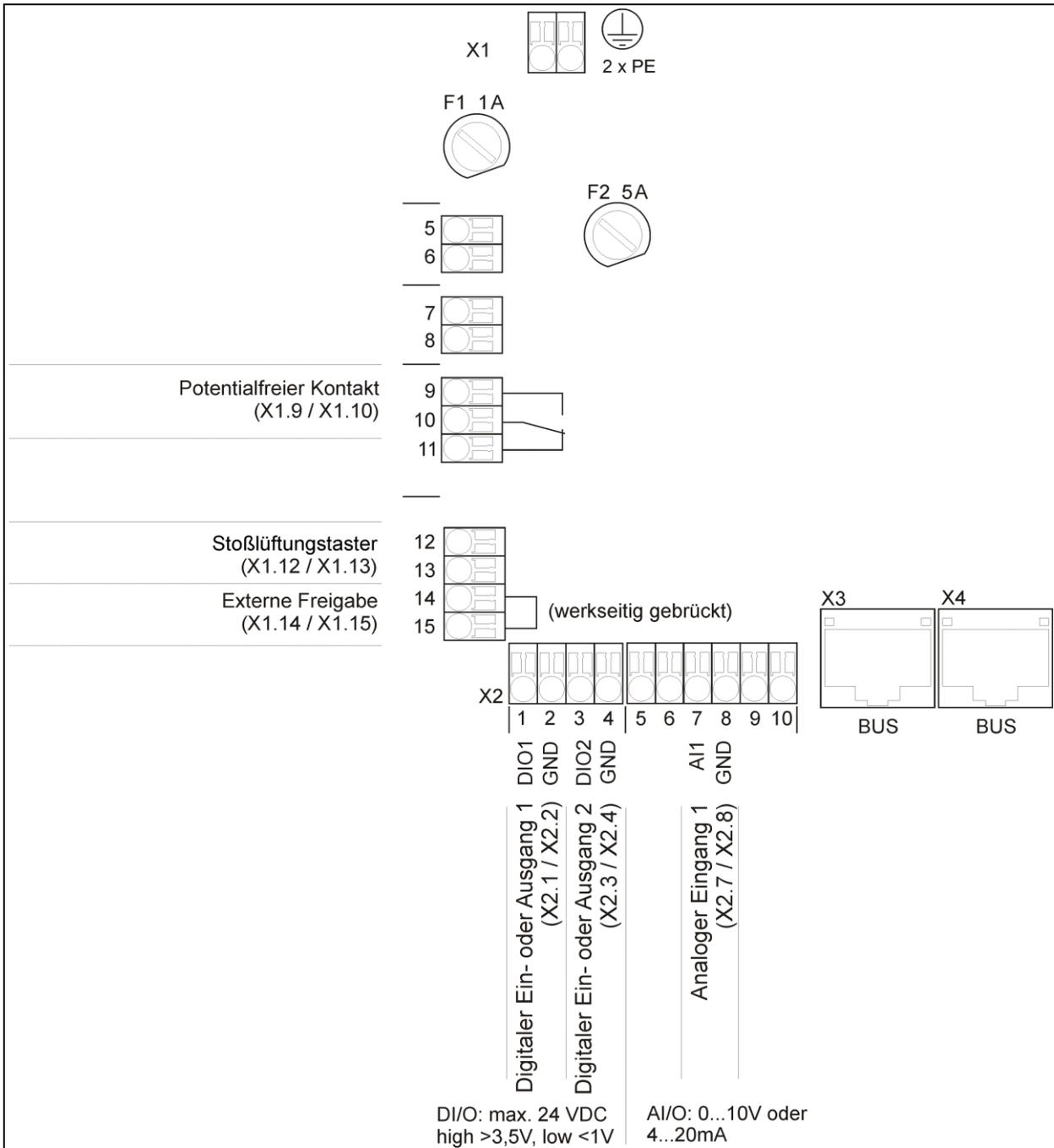
Abb. 46: Klemmenbelegung Master-Controller
