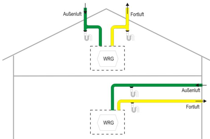
Abb. 28: Anordnung Entwässerung der Außen- und Fortluftleitung
