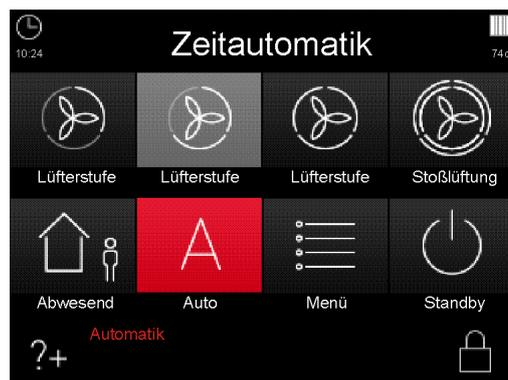
Abb. 10: Automatik-Modus Zeitautomatik mit aktiver Lüfterstufe LS2
