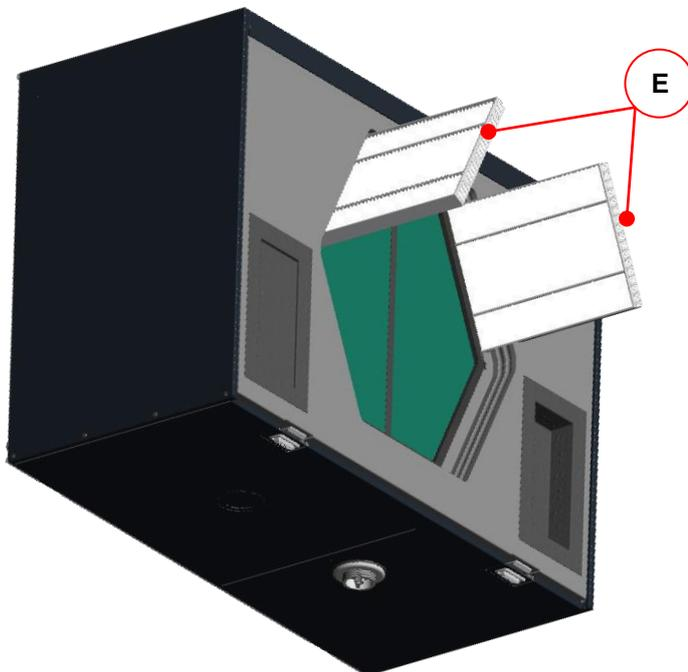
Abb. 14: Herausziehen der Filter
