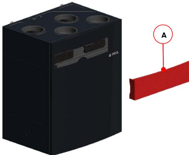
Abb. 42: Abnehmen der Wartungsklappe
