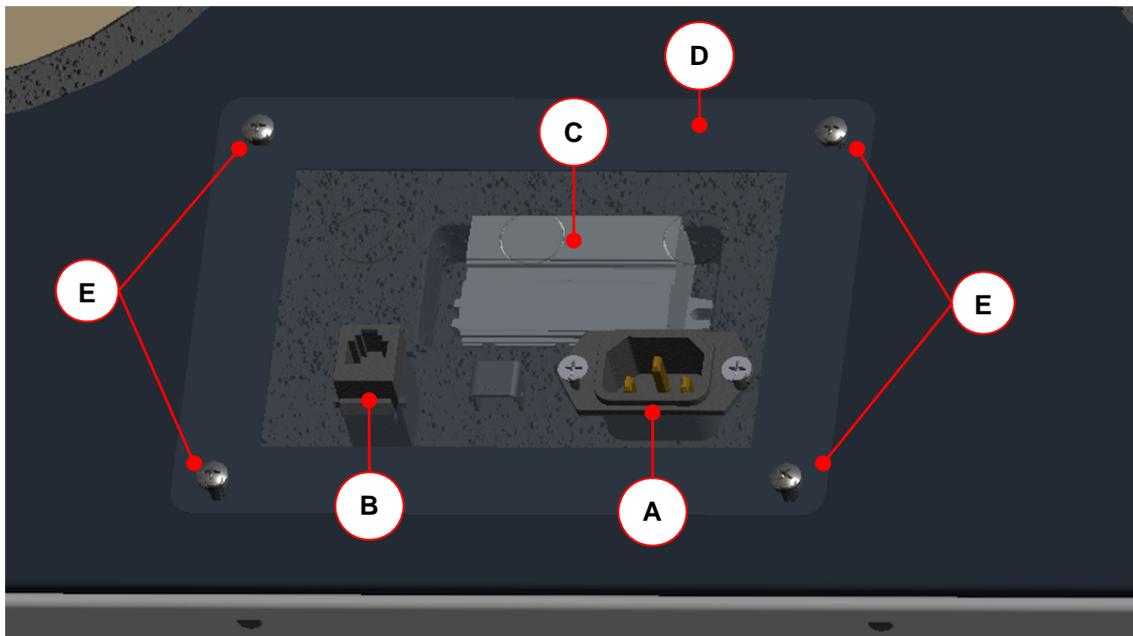
Abb. 34: Gehäuseseite der elektrischen Anschlüsse
