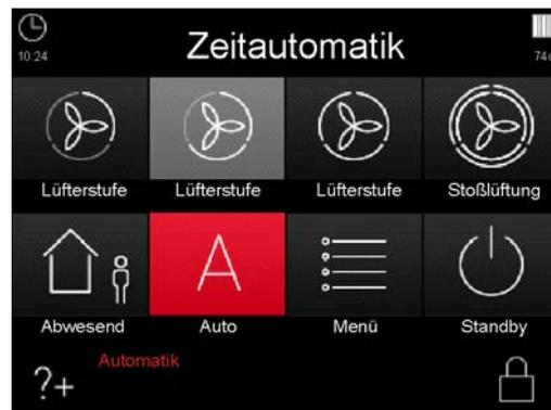
Abb. 11: Automatik-Modus Zeitautomatik mit aktiver Lüfterstufe LS2
