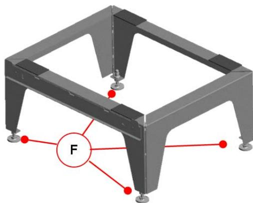
Abb. 28: Justieren des Montage-Sockels
