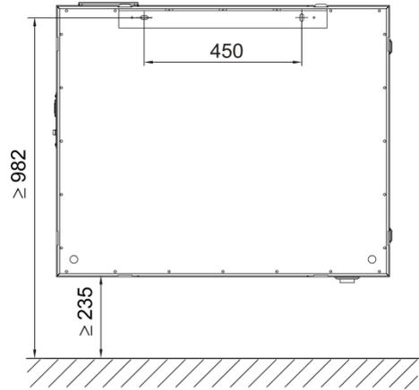
Abb. 20: Einbaulage horizontal (Version
