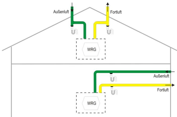
Abb. 30: Anordnung Entwässerung der Außen- und Fortluftleitung
