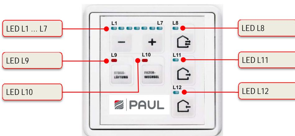
Abb. 6: LED-Signalisierungen LED-Bedienteil
