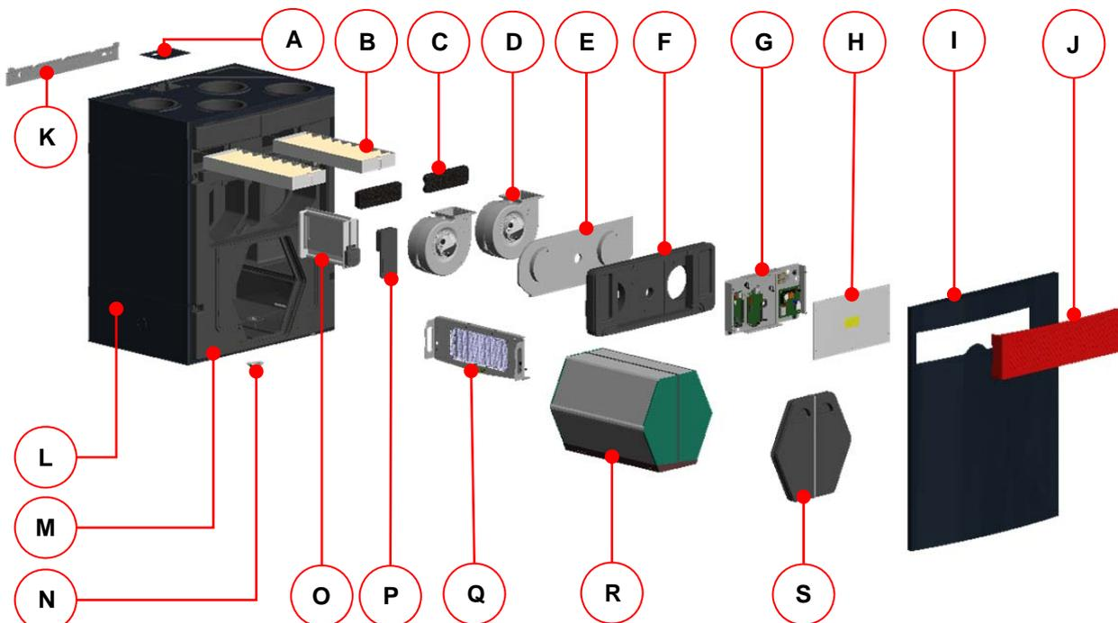
Abb. 1: Hauptkomponenten des Wärmerückgewinnungsgerätes NOVUS
