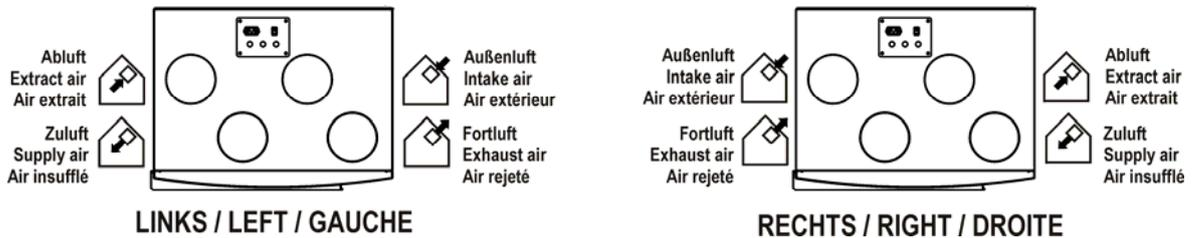
Abb. 29: Anordnung Luftanschlüsse Geräteversion LINKS und Geräteversion RECHTS
