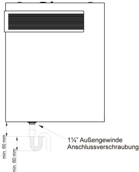
Abb. 32: Kondensatanschluss
