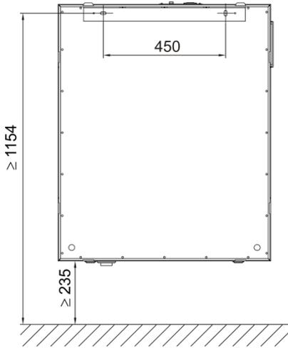
Abb. 19: Einbaulage vertikal
