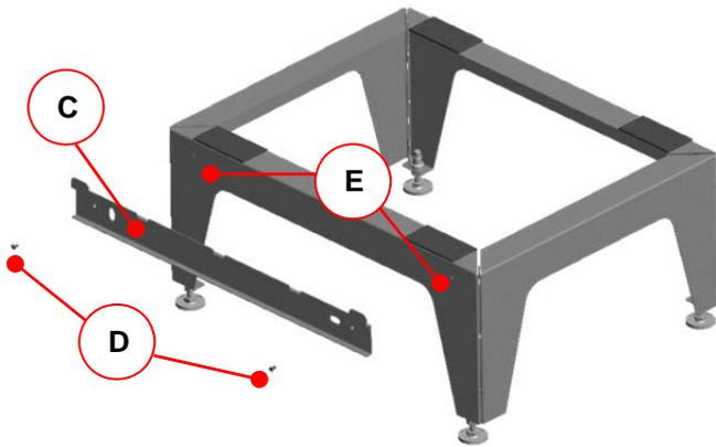
Abb. 27: Montage des Befestigungsbleches an das Fußteil
