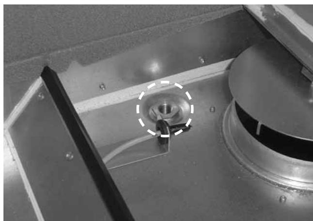
Die Ablauföffnung befindet sich an der Rückseite am Boden des Geräts.
